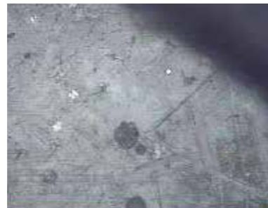
Vakuum = 550 mmHG Keine Risse
