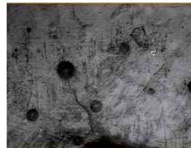
Vakuum = 650 mmHG Risse sichtbar
